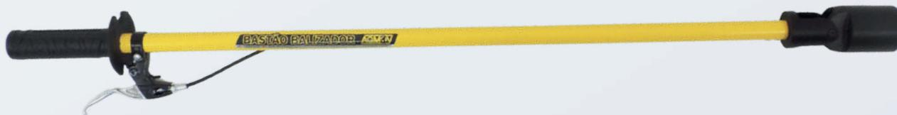
O Bastão Balizador On/Off CG AGMOV foi desenvolvido para direcionar carga com segurança, eliminando riscos de prensamentos ou cortes durante a movimentação da carga. Esse modelo trabalha com **ímã permanente de neodímio e um gatilho, que facilita no momento de desconectar o bastão da carga.** Força de atração do ímã é de 40 kgf. Este modelo é indicado para trabalhar com cargas de até 80°C de temperatura.
