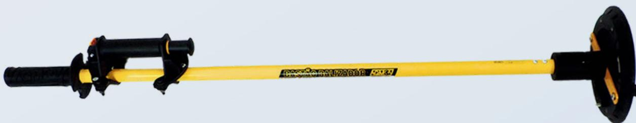
O **Bastão Ventosa** foi projetado para facilitar o manuseio de peças com superfícies lisas e planas, como vidros e chapas de aço. Equipado com uma ventosa de alta capacidade de sucção, pode suportar cargas de até 100 kg. Para fixar a ventosa na carga, basta posicioná-la sobre a superfície desejada, aplicar uma leve pressão e pressionar o botão cerca de 4 vezes para garantir a aderência adequada.
